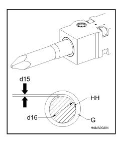
G. Tool Bushing HH. Tool d15. Clearance d16. Tool Diameter
