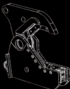
Juego de mandíbulas "K" (Corte de acero) Con puntas de perforación atornilladas (M-35K solamente)
