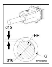
G. Tool Bushing HH. Tool d15. Clearance d16. Tool Diameter
